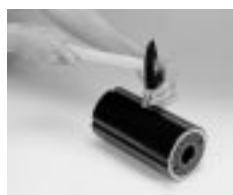
Spannkeil leicht anklopfen
