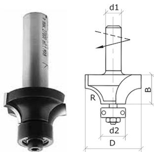
**Abrundfräser Hartmetall bestückt zum Bearbeiten von Mineralwerkstoffen**
